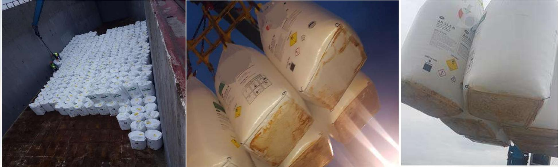
Inspection avant tapissage: Taches de rouilles sur les big bag
